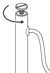
2. ポールにベースを合わせ、ベース裏面から、取り外した固定用ネジを使用し、矢印の方向（時計回り）に回して固定する
