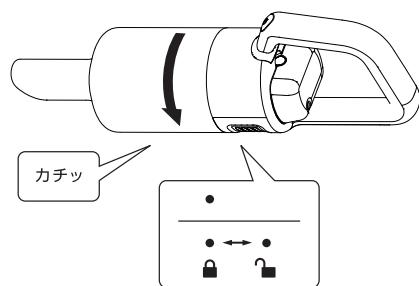
必ずハンディユニット本体「●」マークがダストボックスの「▲」マークに合うように回してください。
