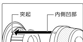
※お手入れ後、フィルターをセットするときは、メッシュフィルターの内側の溝とEPAフィルターの突起の位置を合わせて、セットします。
