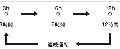
●OFFタイマーボタンを押すたびに右図の順で設定時間が切り換わります。好みの設定時間に合わせてください。
