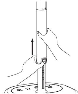
**警告** 使用中にガードを持って上下・左右に風向きをかえない。ガードを持って強く動かすと、羽根がガードにあたる場合があります。羽根の破損、けがの原因になりますので絶対にやめてください。
