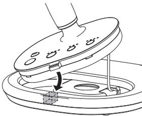
●電源コード通し口から通した電源コードを、ベース底面3カ所のつめにはまるように取り付けます。
