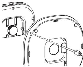
●本体前側の突起を、ベース内側前方の凹部分に差し込み、ベースに本体を取り付けます。
