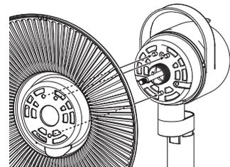
●後ガード止めナットを図の方向にまわして確実に固定します。
